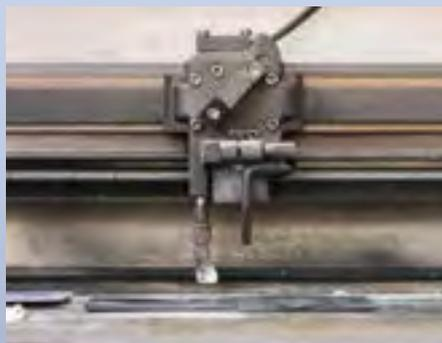
Mit einem Laser wird das Stempelrelief aus einem Gummirohling geschnitten.
