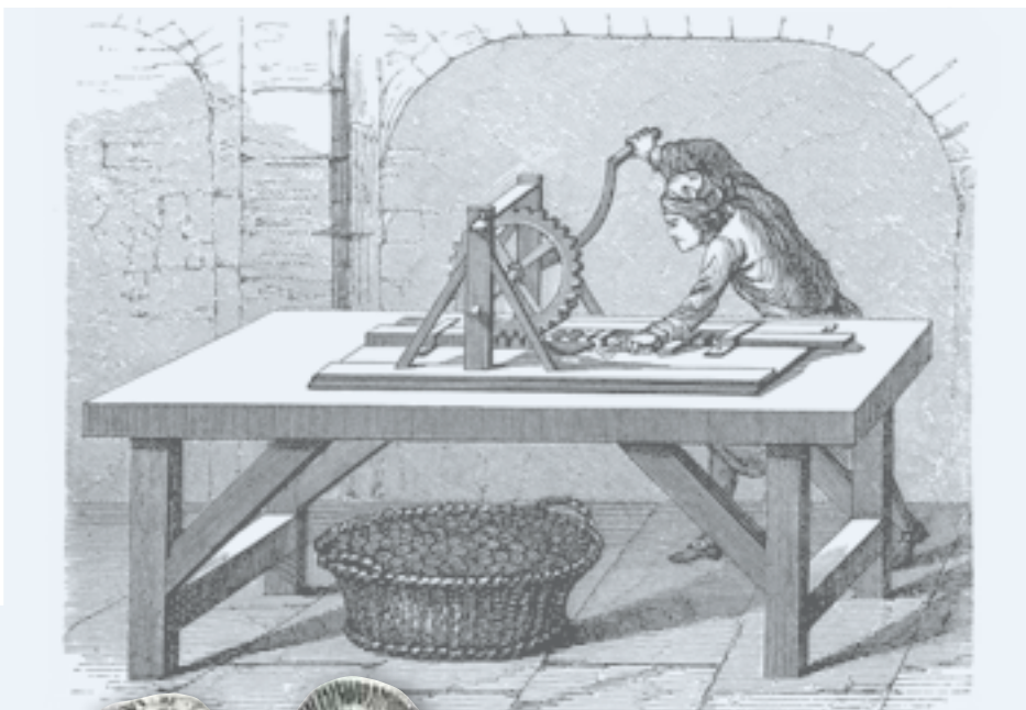
Diese historische Darstellung zeigt die Prägung des Münzrandes mit einem Rändelwerk.
