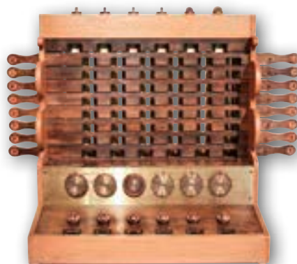
Rekonstruktion der Rechenmaschine von Schickard im Stadtmuseum Tübingen
